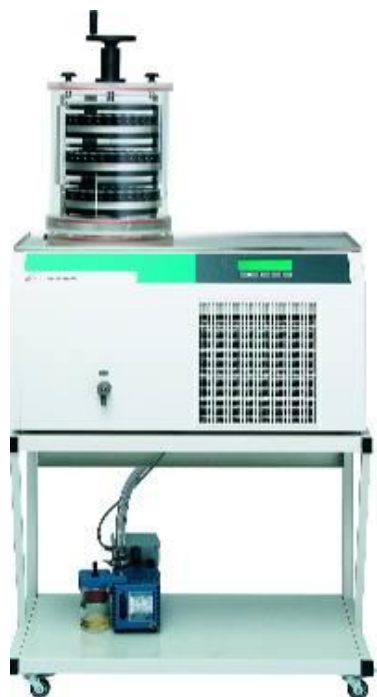
2-сурет. Heto power dry pl6000 маркалы леофильді кептіру қондырғысы
