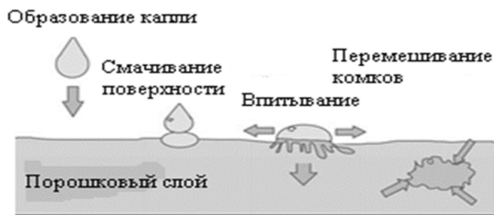
Рисунок 1 - Увлажнение и образование зародышей гранул в брызговой зоне гранулятора.
